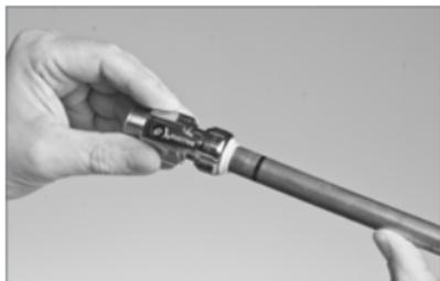
Bei der Montage verchromter Kupferrohre sind vorgängig aufzurauchen, um einen sicheren Halt des Steckfittings zu gewährleisten.
