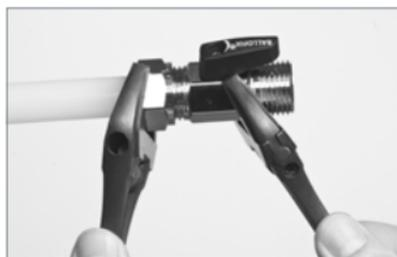
3. Montieren Sie Überwurfmutter, Schneidring und Kugelhahn.
