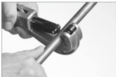
Nach dem Aufmaß können die Rohre mithilfe eines Rohrschneiders, einer fein gezahnten Handsäge oder einer für das Rohrmaterial geeigneten Elektrosäge gekürzt werden. Das Rohr muss immer vollständig durchgesägt werden. Das Rohr darf niemals teilweise durchgesägt und dann gebrochen werden, da dies das Korrosionsrisiko erhöht. Die für rostfreien Stahl verwendeten Schneidwerkzeuge dürfen nicht zuvor für andere Materialien verwendet worden sein.
