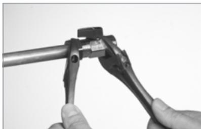
3. Montieren Sie Überwurfmutter, Schneidring und Fitting.
