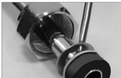
Überwurfmutter abschrauben. Der Schneidring wird mit einem Schraubendreher oder einer Kneifzange durchtrennt. Anschließend lässt sich die Verbindung einfach und schnell demontieren.
