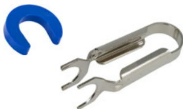
Verwenden Sie das Demontagewerkzeug um den Steckfitting zu lösen. Die Gabelseite wird um das Rohr gelegt, die entgegengesetzte Seite um die Fittings.
