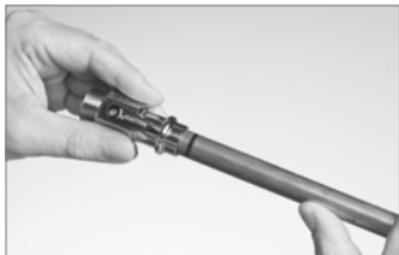
Schieben Sie das Rohr vorsichtig in den Kugelhahn, bis die Markierung der Einstecktiefe erreicht ist. Dabei wird das Rohr gedreht und senkrecht eingesetzt. Die Kennzeichnung der Einstecktiefe muss sichtbar bleiben. Grobes oder unvorsichtiges Einsetzen des Rohrs in den Kugelhahn kann den O-Ring beschädigen und ist daher zu vermeiden.
